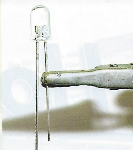
Leuchtdiode (LED) mit den typischen Anschlüssen Anode (lang) und Kathode (kurz)
